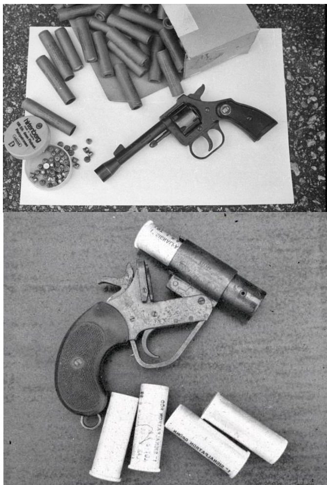
Fig. 11. Spesialrevolvere for utskytelse av prosjektiler som smeller etter en viss avstand (teleshot / pyroknall) eller lager en hvinende høyfrekvent lyd (pyropfeif). Spesielt benyttet i kombinasjon med bioakustiske metoder dvs. utsendelse av de aktuelle fugleartenes varselsskrik, oppnådde jeg en god skremmeeffekt. Målet var ideelt å skremme fuglene ut av lufthavnen, sekundært at de forflyttet seg til et område der de ikke utgjorde noen trussel ved flybevegelser.
