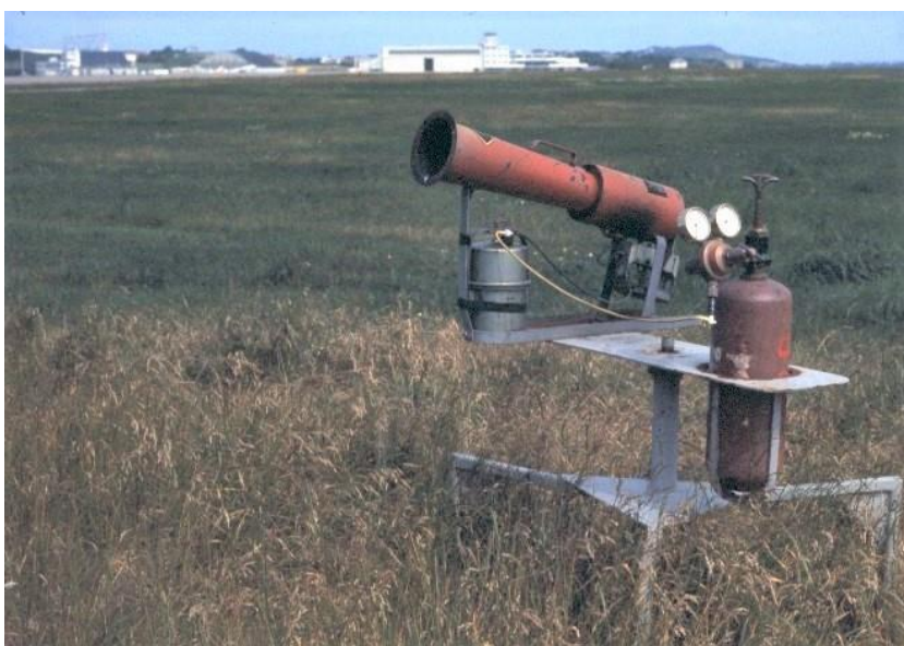
Fig. 10. Acetylen kanonen oppsatt ute på Sola lufthavn for skremming av fugleflokker (uansett art) som slo seg ned på gresslettene i relativ nærhet til kanonen. En klar tilvenning til smellene ble observert hos de enkelte fugleartene.
